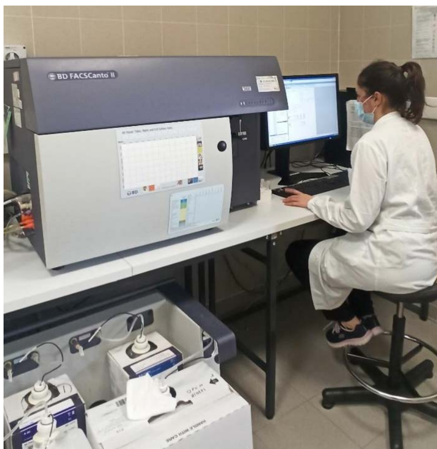
figura 3. Utilizzo di un citofluorimetro, una delle strumentazioni del Laboratorio di Immunopatologia Virale.
