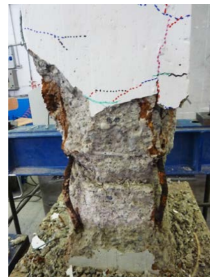
figura 2. Pilastro con armature longitudinali corrose e soggetto a carichi ciclici fino al raggiungimento della rottura per instabilità delle barre longitudinali (Meda, A., Mostosi, S., Rinaldi, Z., Riva, P., "Experimental evaluation of the corrosion influence on the cyclic behaviour of RC columns", Engineering Structures, 76, 2014, 112-123).
