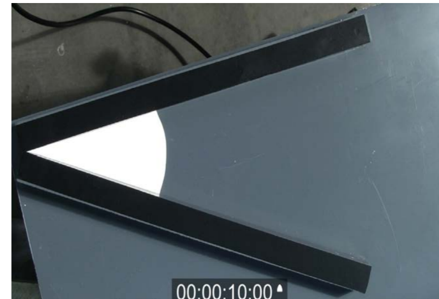
figura 2. Sospensione di amido di mais in acqua: propagazione della corrente su di un piano in condizioni di simmetria assiale (per semplicità l'esperimento è stato condotto su un settore circolare con ampiezza limitata). L'immissione avviene al centro del settore, tramite un foro praticato nel pannello in PVC.
