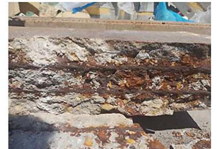
figura 3. Trave precompressa caratterizzata da corrosione naturale indotta da cloruri testata presso l'Istituto Eduardo Torroja (Madrid).
