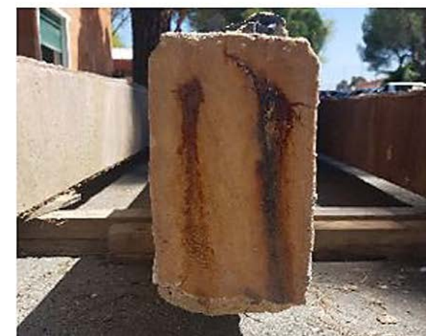
figura 3. Trave precompressa caratterizzata da corrosione naturale indotta da cloruri testata presso l'Istituto Eduardo Torroja (Madrid).
