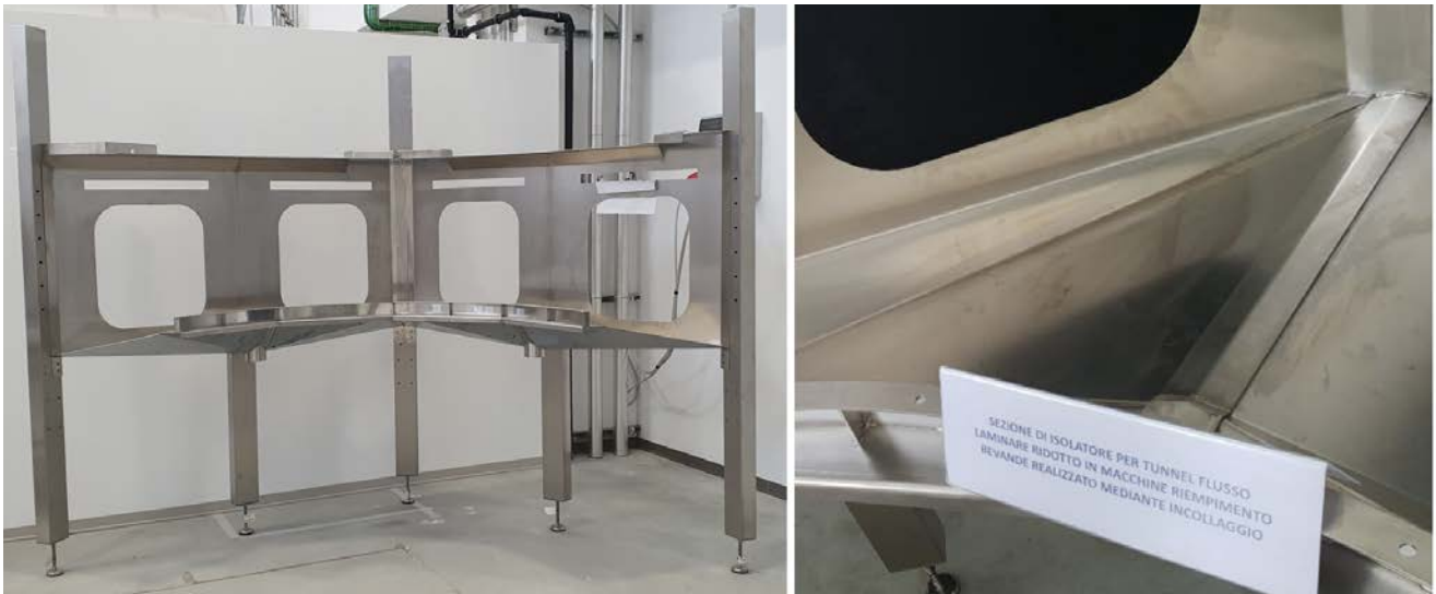
figura 1. Incollaggio di moduli dell'isolatore di una riempitrice per bevande: vista complessiva (a sinistra) e dettaglio (a destra).
