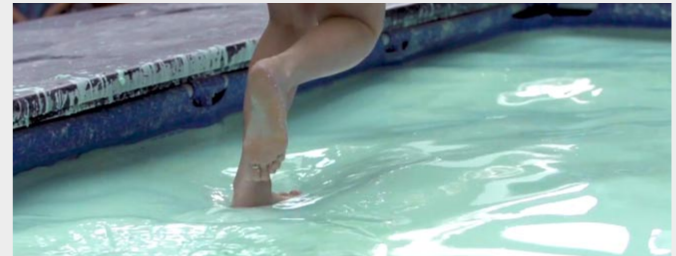
Esempio di fluido non-newtoniano: acqua contenente amido di mais in proporzione 1:1.5
