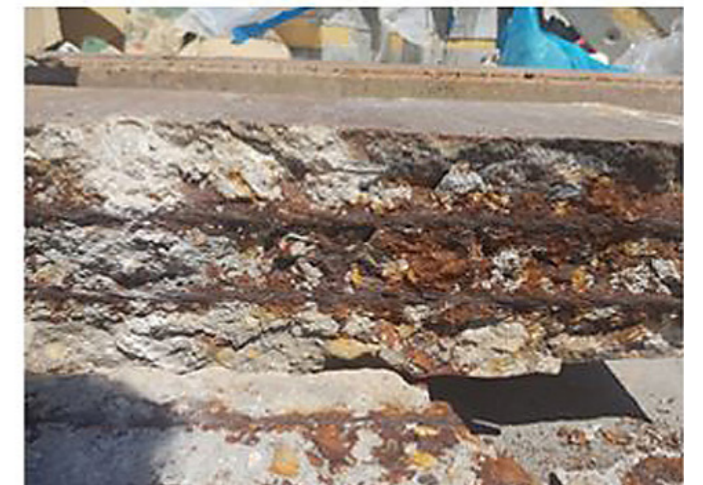
figura 3. Trave precompressa caratterizzata da corrosione naturale indotta da cloruri testata presso l'Istituto Eduardo Torroja (Madrid).
