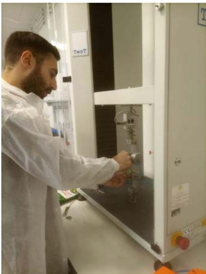
**figura 1.** Macchina per le prove di trazione di campioni di materiali compositi. a quelle morfologiche (microscopia ottica ed elettronica) e strutturali (Spettroscopia UV-VIS, FTIR, Raman).
