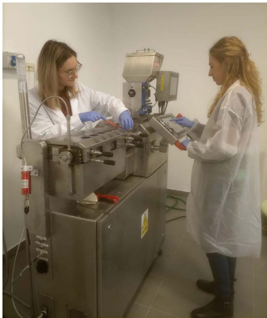
**figura 2.** Estrusore bivate per la realizzazione di nuovi materiali a base polimerica.
