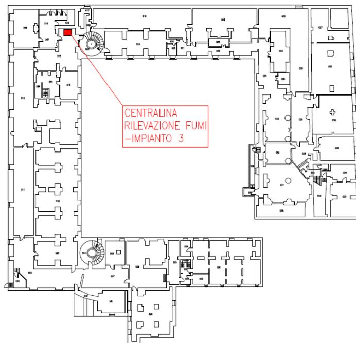
Figura 1.c. Planimetria impianti gestione emergenze – IMPIANTO 3.
