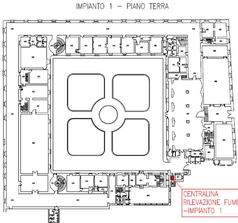
Figura 1.a. Planimetria impianti gestione emergenze – IMPIANTO 1.
