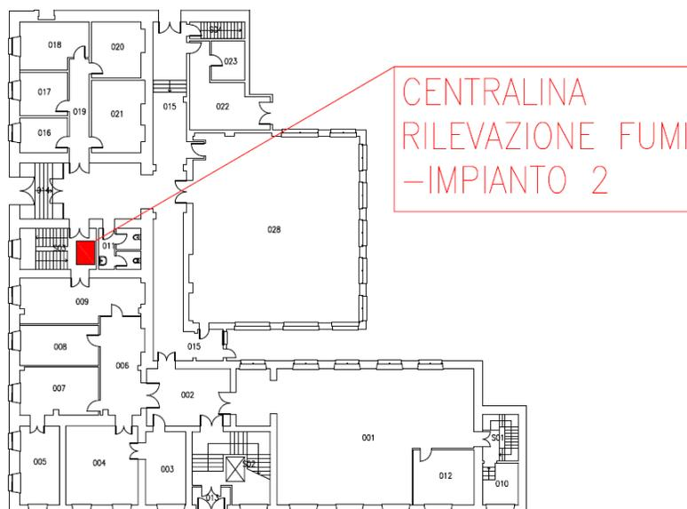
Figura 1.b. Planimetria impianti gestione emergenze – IMPIANTO 2.
