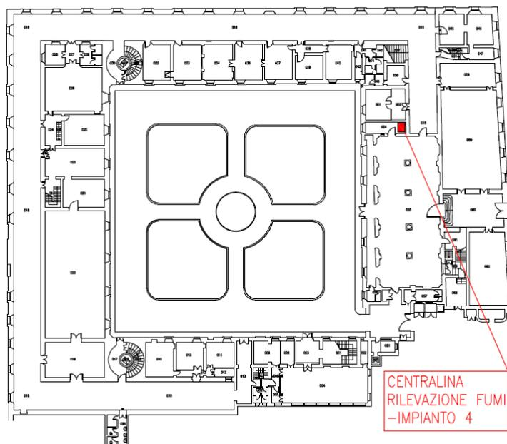
Figura 1.d. Planimetria impianti gestione emergenze – IMPIANTO 4.
