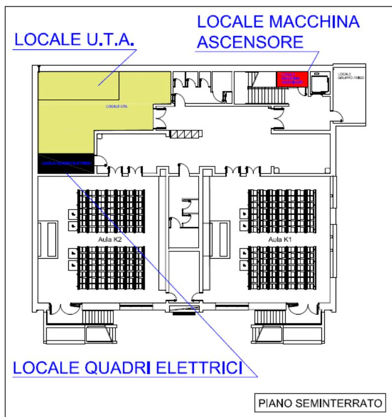
Figura 2.1 - Ubicazione impianti tecnologici – Piano Seminterrato.
