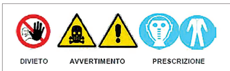
Figura 4 - Esempi di segnalazione di aree a rischio
