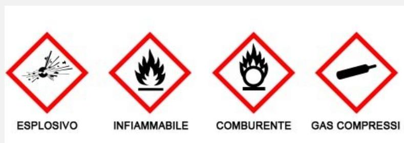
Figura 1. Regolamento CLP – Identificazione grafica delle sostanze pericolose ai fini dell'incendio
