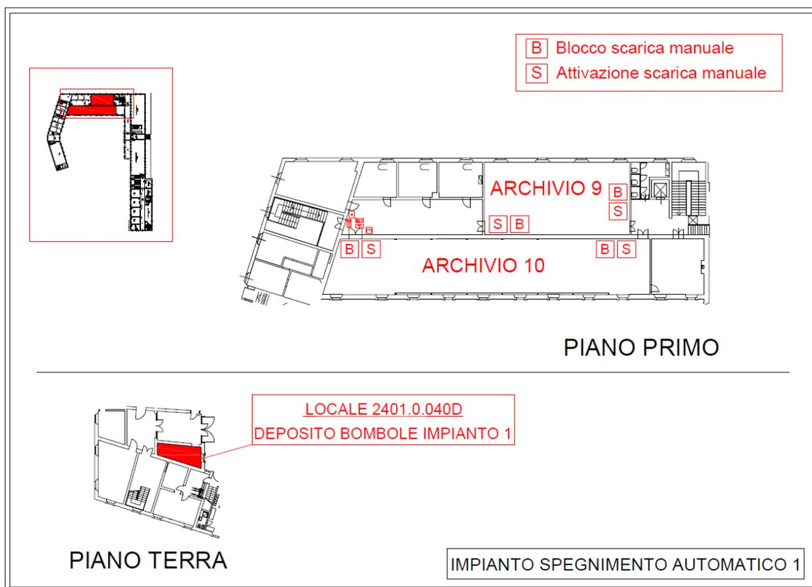
Figura 2.1 - Impianti spegnimento automatico 1.
