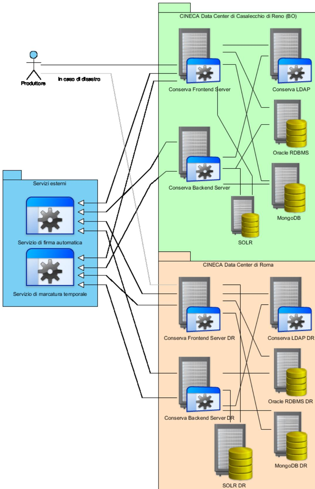
Figura 4 - Distribuzione topologica delle componenti fisiche di Conserva
