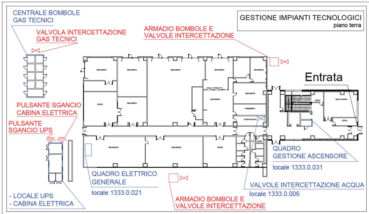
*Figura 2.1. Ubicazione impianti tecnologici – piano terra.*
