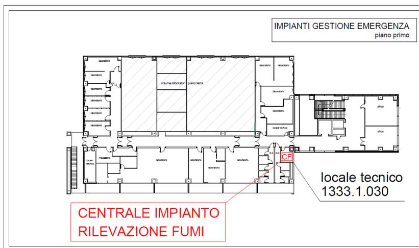
Figura 1. Ubicazione centrale di comando dell'impianto IRAI (piano 1).
