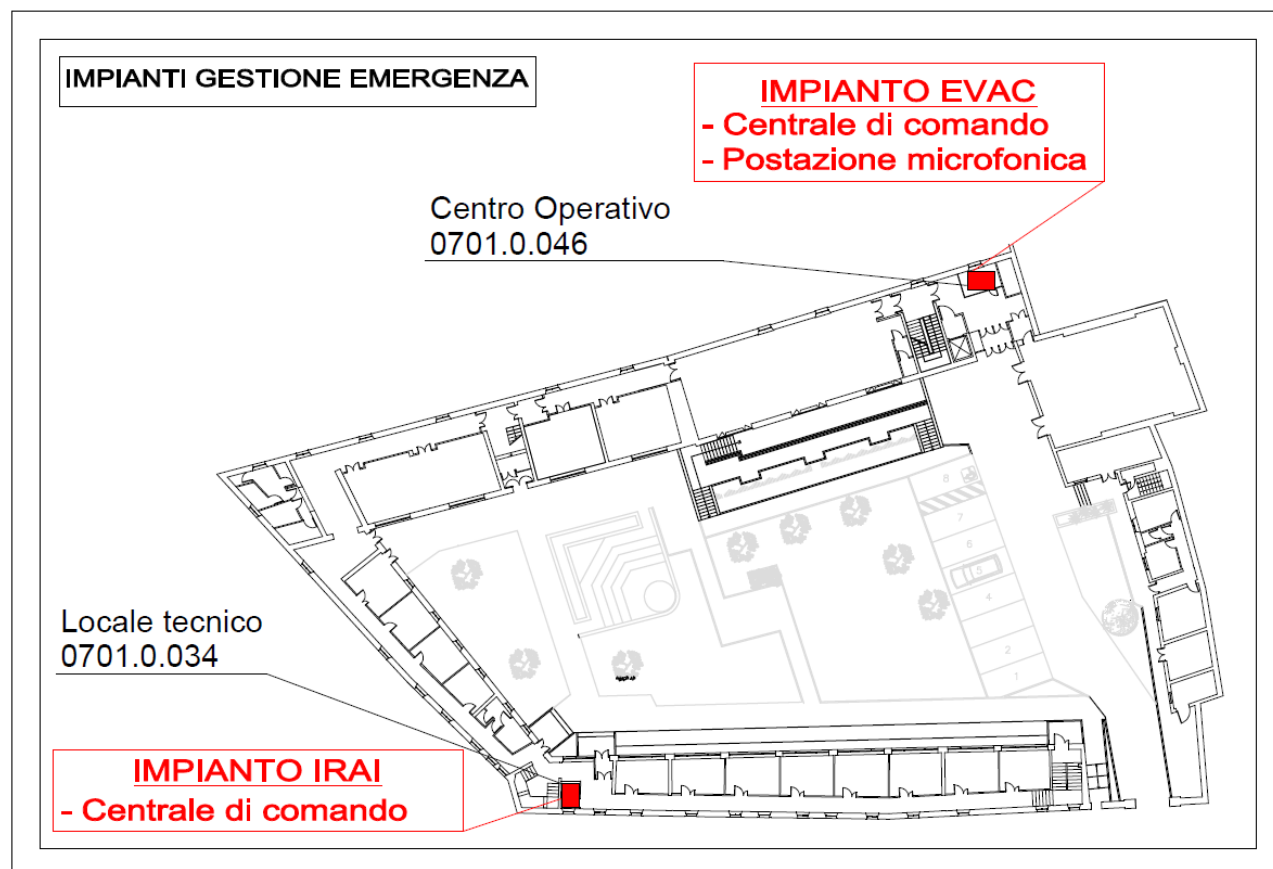
Figura 1 - Impianti gestione emergenze
