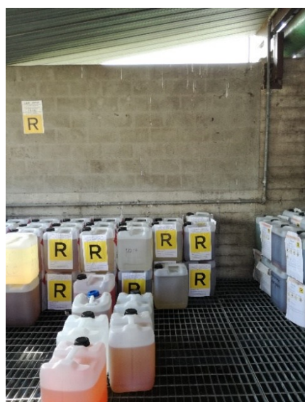
Figura 11 - Esempio di stoccaggio di rifiuti pericolosi in deposito esterno
