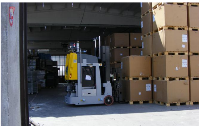
La navetta senza pilota mentre carica dei pallet in una azienda di Mirandola e il gruppo di lavoro durante una operazione di svuotamento con operatore remoto
