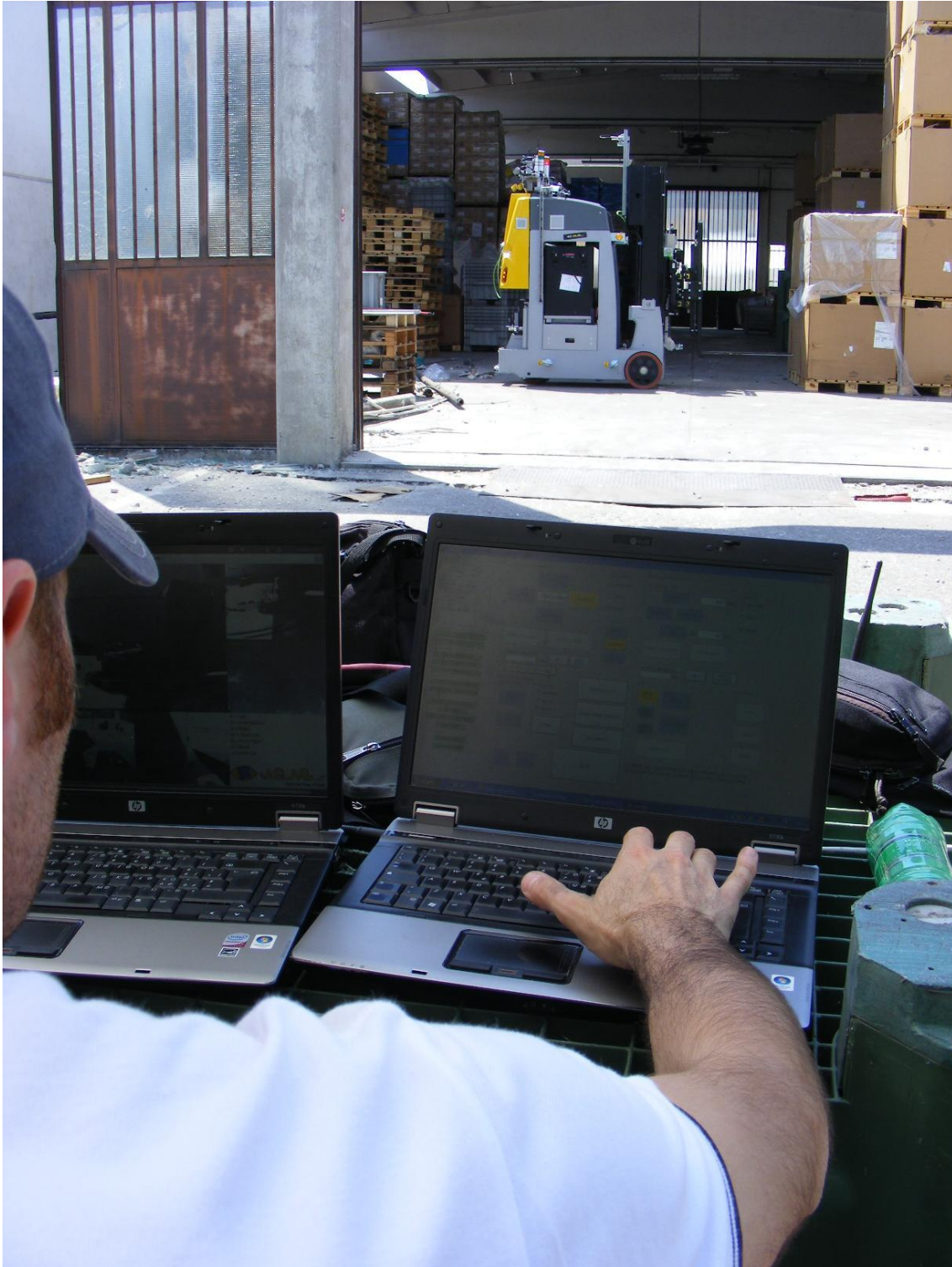
Un operatore controlla la movimentazione della navetta da una postazione sicura all'esterno del magazzino
