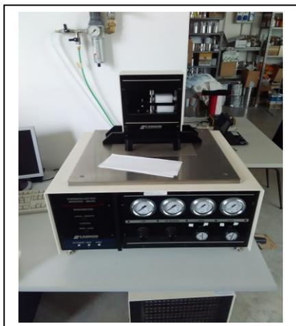
IOS.30 BENDING BEAM RHEOMETER (BBR)
