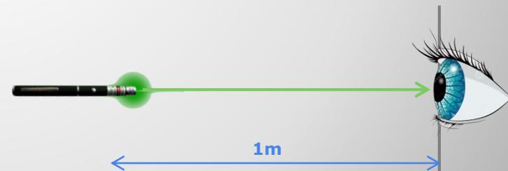
$$P_{\text{occhio}} = (12 \times 10^{-2}) \times (3,8 \times 10^{-5} \text{ m}^2) = 4,56 \times 10^{-6} \text{ W}$$
