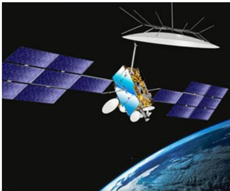
Figura 9: Il satellite Eutelsat W2A con il riflettore da 12 m per la banda S.
