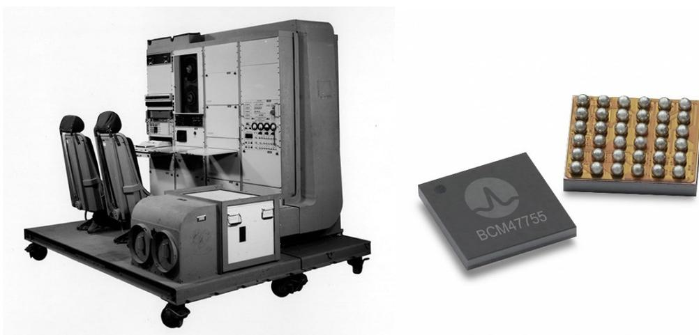
Figura 16: L'evoluzione della tecnologia dei ricevitori GPS: a sinistra primo ricevitore GPS aeronautico (1977), a destra il primo chip con doppia banda di ricezione multi-costellazione GNSS (2017) per applicazione al mercato di massa (e.g. telefoni cellulari).
