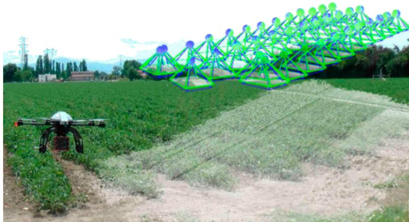
sviluppato una nuova piattaforma multisensoriale per il rilievo delle condizioni di stress idrico delle colture. I rilievi sono stati effettuati anche con l'ausilio di droni per produrre mappe di dettaglio per un'irrigazione a rateo variabile: il campo viene suddiviso in celle e a ciascuna di esse viene assegnata una specifica ragione di acqua ottimizzata rispetto all'esigenza in quel punto della coltura.
