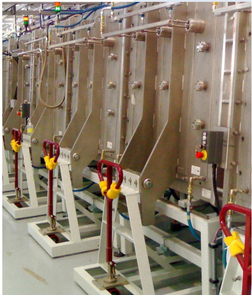
**figura 3.** Il cuore della linea produttiva di moduli fotovoltaici a base di CdTe assemblata nel 2011: impianto di Close-Spaced Sublimation (CSS), completo del tunnel di riscaldamento a 550°C e di raffreddamento a temperatura ambiente, per la deposizione dello strato assorbitore (CdTe). Nel 2011 con queste macchine si sono ottenuti moduli di area 1 m<sup>2</sup> ed efficienze superiori al 13%.
