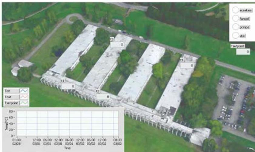
figura 1. Il sinottico del controllore MPC ("Model Predictive Control") operante da due stagioni sul ramo della rete che alimenta l'edificio di Scienze della Terra al Campus.
