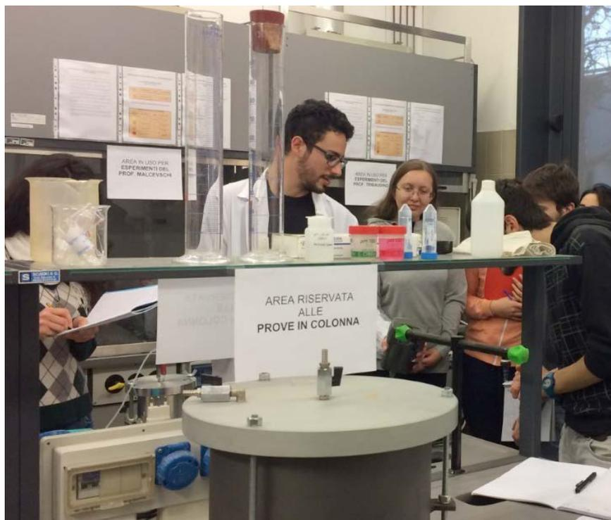
*figura 5. Attività didattica effettuata all'interno del Laboratorio di Idrogeologia del Plesso di Scienze della Terra. Questa attività di laboratorio è finalizzata alla simulazione della migrazione di contaminanti idrovelicolati in mezzi porosi ed è rivolta contemporaneamente a studentesse e studenti dei Corsi di Studio magistrali in Scienze Geologiche applicate alla Sostenibilità Ambientale, Scienze e Tecnologie per l'Ambiente e le Risorse, Ingegneria per l'Ambiente e il Territorio.*
