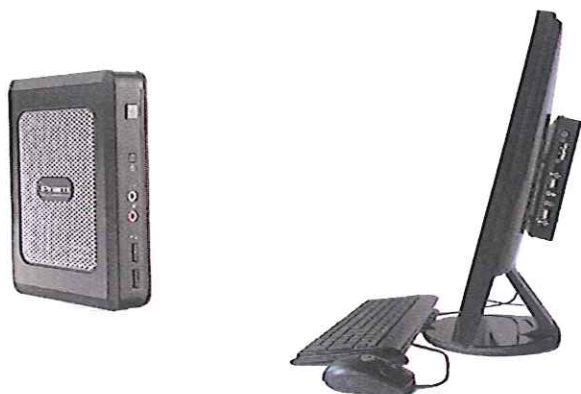
Fig. 3 Le postazioni virtuali con la soluzione dei thin client.
